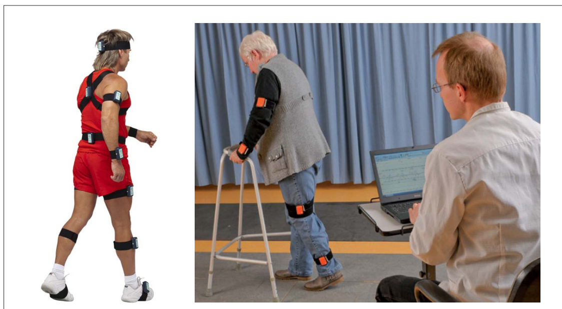
Рис. 3. Регистрация движений при ходьбе посредством инерционных безплатформенных комплексов: «Trust-M» компании Неврокор (Россия), Xsens (Нидерланды).
